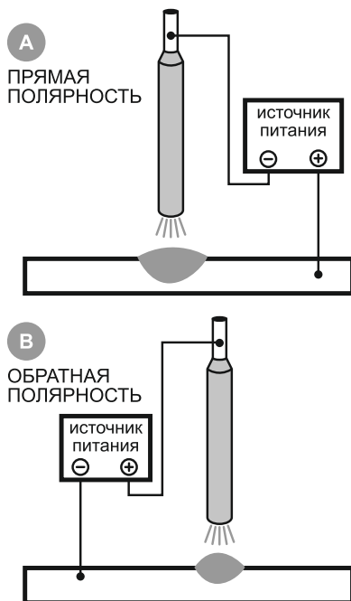
Рис. 3. Места установки сварочных кабелей
